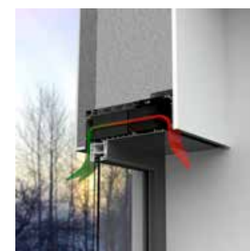
Nedadgående lufttilførsel + gipskant
